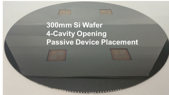
図2 デバイスダミーマウント後の表面
